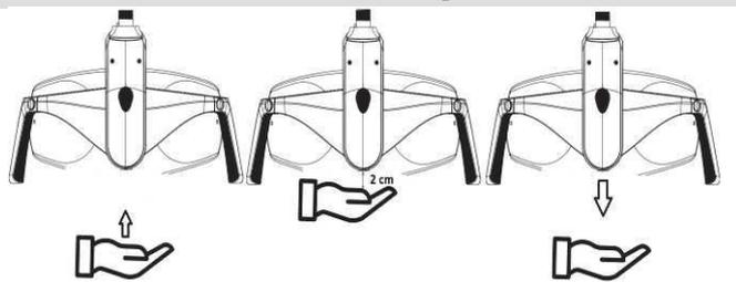
Approcher la main du capteur jusqu'à 2 cm et baisser la main
