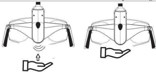
Approcher la main du capteur jusqu'à 2 cm et maintenir cette distance jusqu'à ce que l'intensité lumineuse souhaitée soit atteinte
