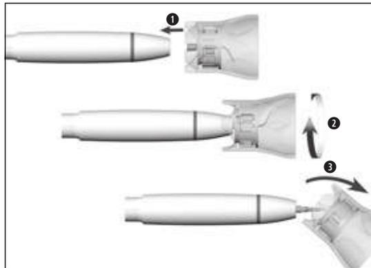
**Insertion de l'insert avec la clé de changement d'insert**
