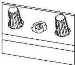
L'intensité du spray pour les instruments peut être réglée sous l'unité praticien. La position des groupes électrovannes (triples) pour chaque instrument est en fonction de l'instrument dans les supports du carquois. L'intensité du spray peut être réglée à l'aide des boutons ou molettes. L'air de propulsion pour la turbine ou l'air de refroidissement pour le moteur peut être réglé à l'aide d'un tournevis cruciforme.
